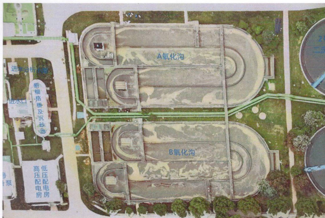
照片一：氧化沟平面示意图
